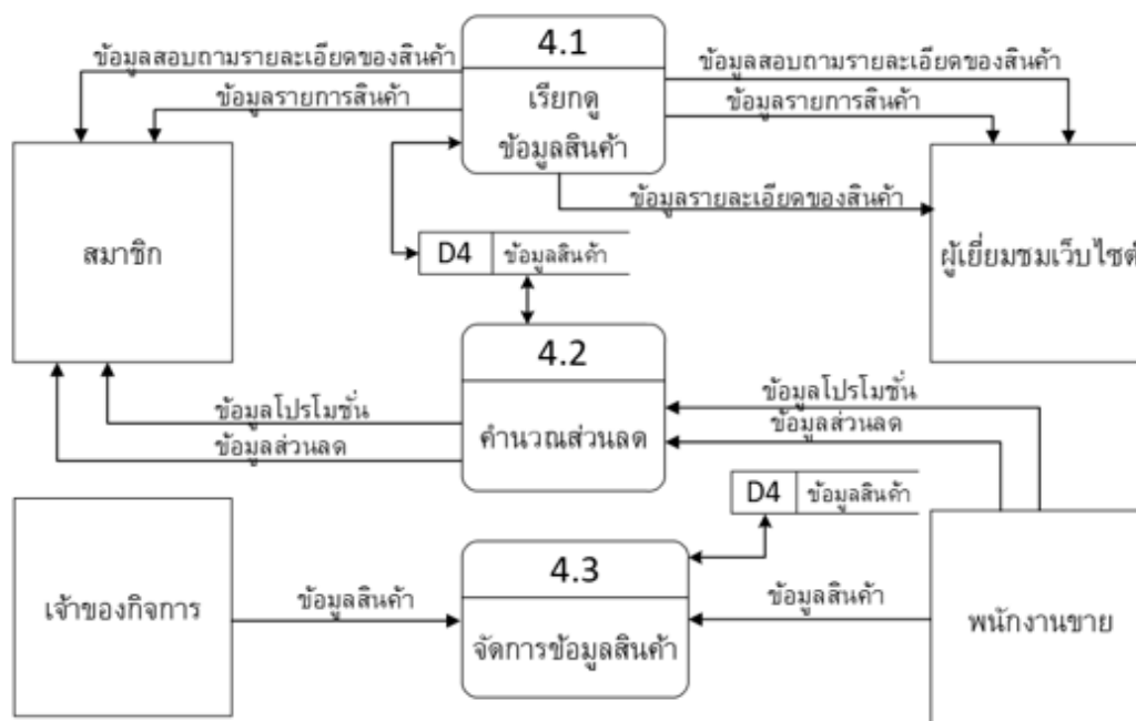
ภาพที่ 3.7 แสดงแผนภาพกระแสข้อมูลระดับที่ 1 Process 4.0 จัดการข้อมูลสินค้า
